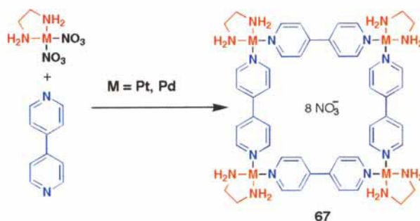
Abb. 51. Tetramere Bipyridinmakrocyclen sind durch metallgesteuerte Selbstorganisation leicht zugänglich.
